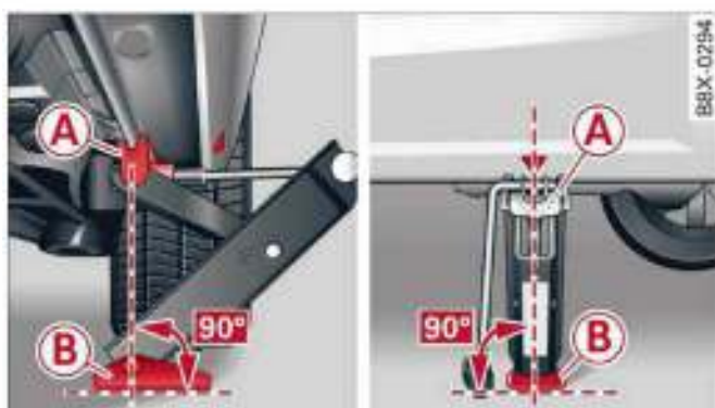
Fig. 162 Door sill: Applying the jack under the door sill
