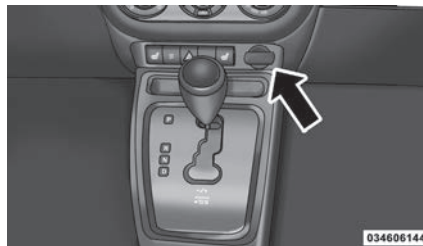
12 Volt Power Outlet
