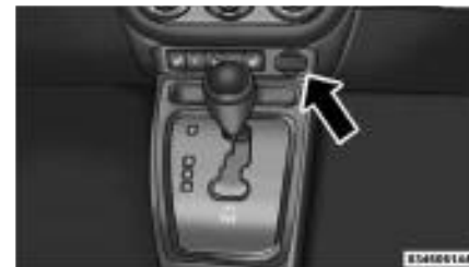
12 Volt Power Outlet
